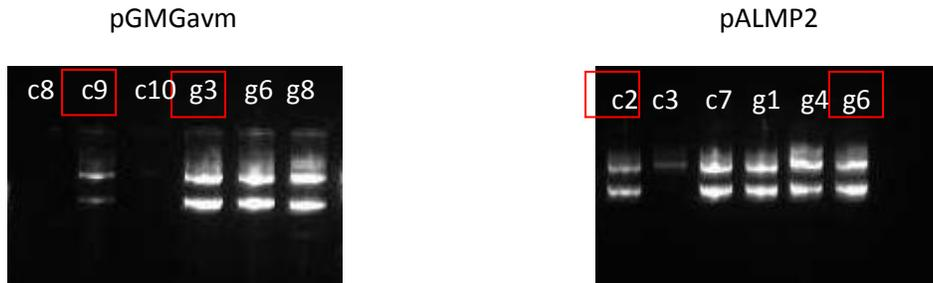
Las clonas c9 y g3 del plásmido pGMGavm así como las clonas c2 y g6 del plásmido pALMP2 se cultivaron en 10 ml de LB con 100  $\mu$ g/mL de ampicilina durante 12-16 hr. Al cabo de ese tiempo las células fueron centrifugadas y el DNA plásmidico se purifico por kit para ser analizados por restricción.
