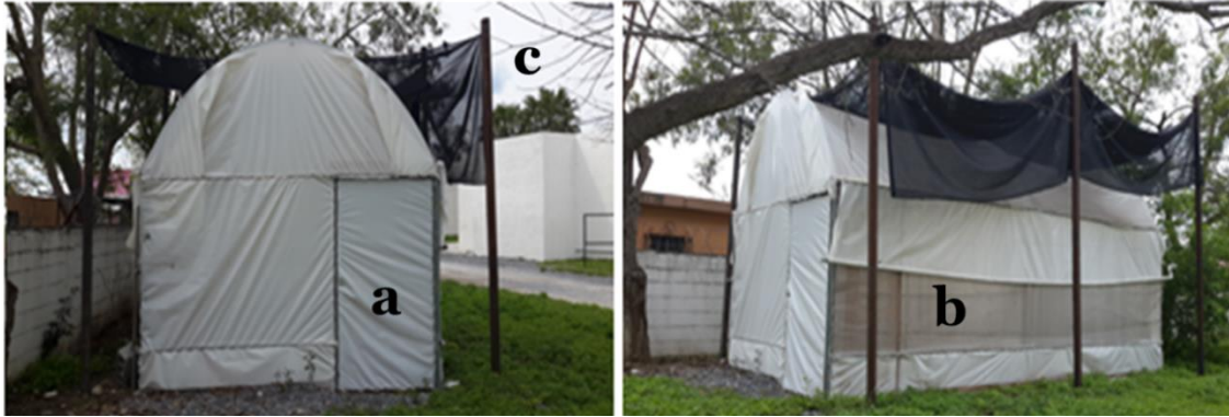
Figura 32. Estación biológica (fabricado por grupo Xaxeni®, Edo. de México, México) utilizada en los bioensayos de semi-campo. a. puerta doble de seguridad, b. entradas de aire y c. malla sombra.
